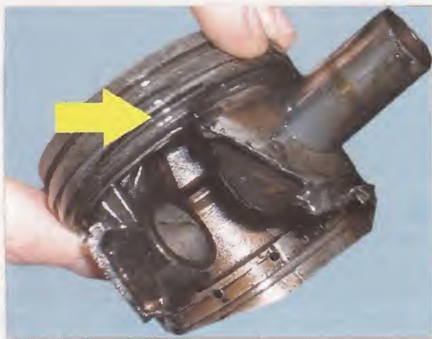
Daño de los anillos
